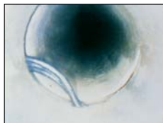
Fig. 2 - Erniatura di una guarnizione "tradizionale" che provoca la fuoriuscita del liquido trasportato (pericolo di inquinamento dell'ambiente) e anomala sedimentazione dalla fase solida dei liquami con conseguente variazione delle condotte idrauliche.
