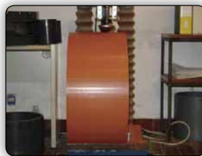
Fig. 25 - Prova ad urto UNI EN 744.
