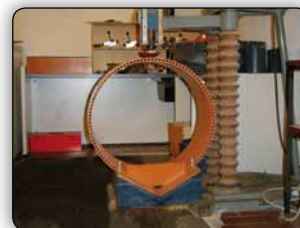
Fig. 26 - Prova ad urto UNI EN 744.
